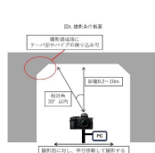
デジタルカメラによる溝橋の点検
